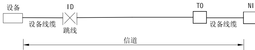
图 3.7.8 中间配线子系统构成
